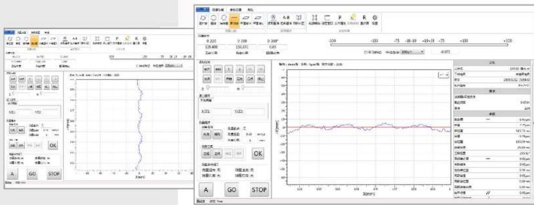
支持橫向，縱向測量測量結果可放大至 10 萬倍，能夠直觀清楚看到工件表面的直線度
