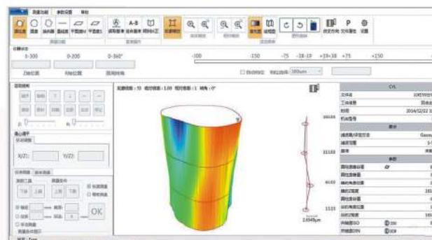
多截面測量結果組成一個 3 D 可旋轉圓筒度，真實反映了工件的輪廓形狀。
