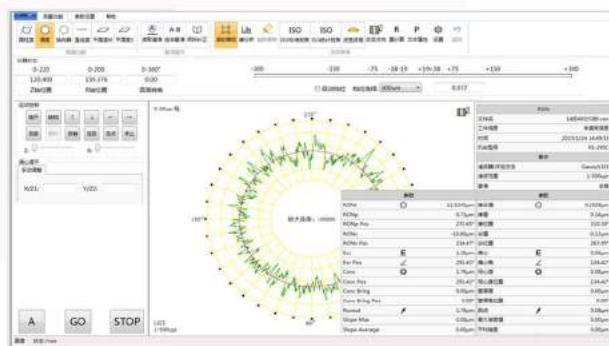
測量單截面圓度，可提供標準報表（可支援繁簡、英文切換）及統計報表並顯示頻譜分析及波寬、波高的結果。
